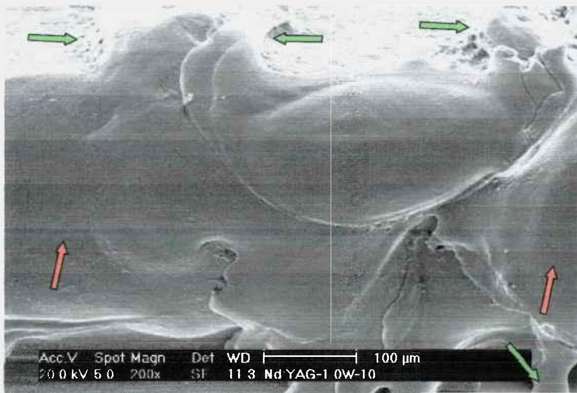
Figura 40 – Micrografia eletrônica de um implante em maior aumento da região demarcada em vermelho na FIG. 39 localiza a área irradiada com laser de Nd:YAG a 1.0W (amostra G3ar10). A área irradiada apresentou alteração morfológica tipo fusão localizada com setas em vermelho e fusão seguido de solidificação localizado com setas em verde.
