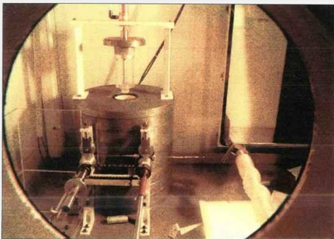
Figura 13 - "Hot cell" para manipulação do fio radioativo - controle de qualidade
