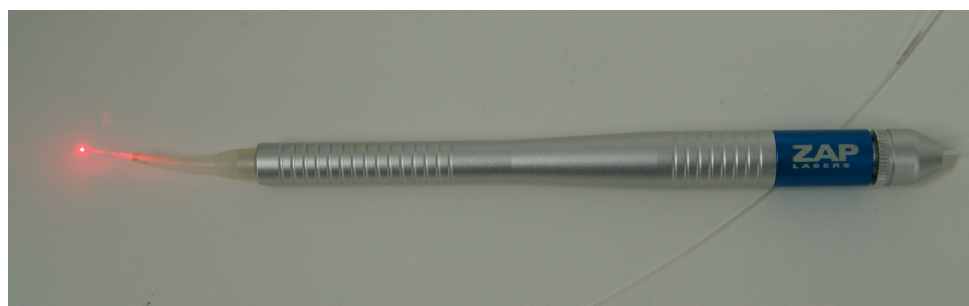
Figura 3 – Sistema de entrega de feixe por fibra óptica de quartzo com 300 \mu m.
