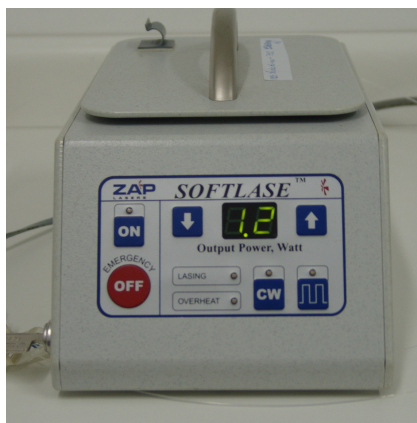
Figura 8 – Laser Diodo, marca ZAP Lasers, ajustado no modo contínuo com potência de 1,2W.
