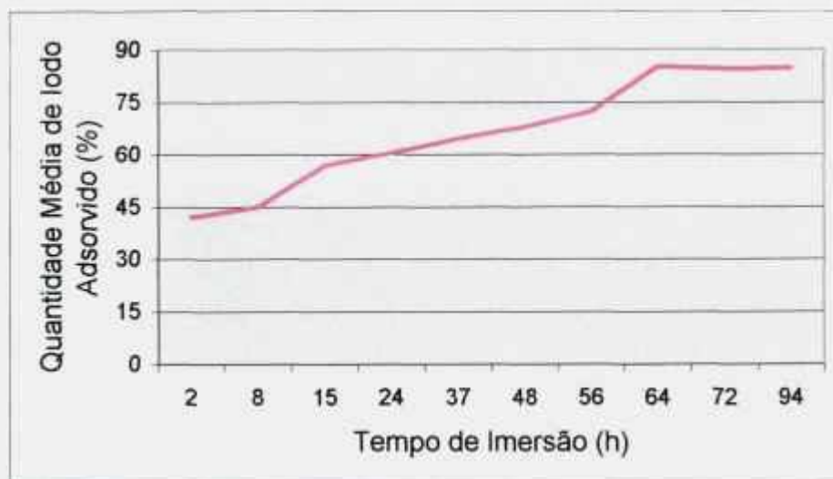
FIGURA 42 – Quantidade média de iodo-131 adsorvido na prata por tempo de imersão na solução de sulfeto de sódio.
