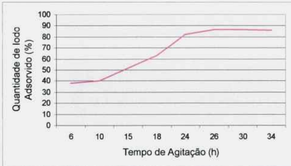
FIGURA 43 – Quantidade de iodo-131 adsorvido por tempo de agitação.
