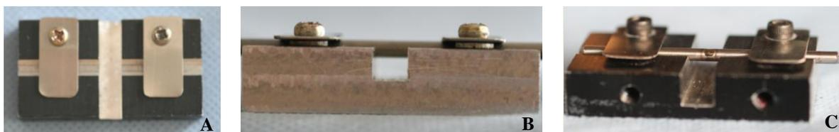
**FIGURA 4** – Dispositivo de fixação (A, vista superior; B, vista frontal e C, após redução na lateral).
