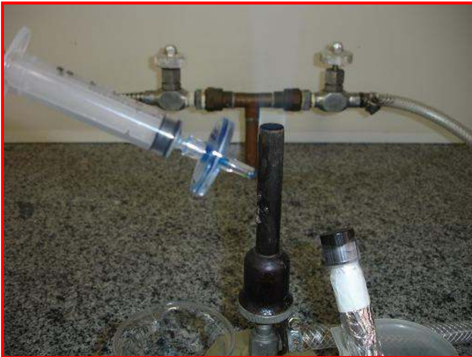
Figura 5 – Esterilização da solução de Azul de Metileno por filtração
