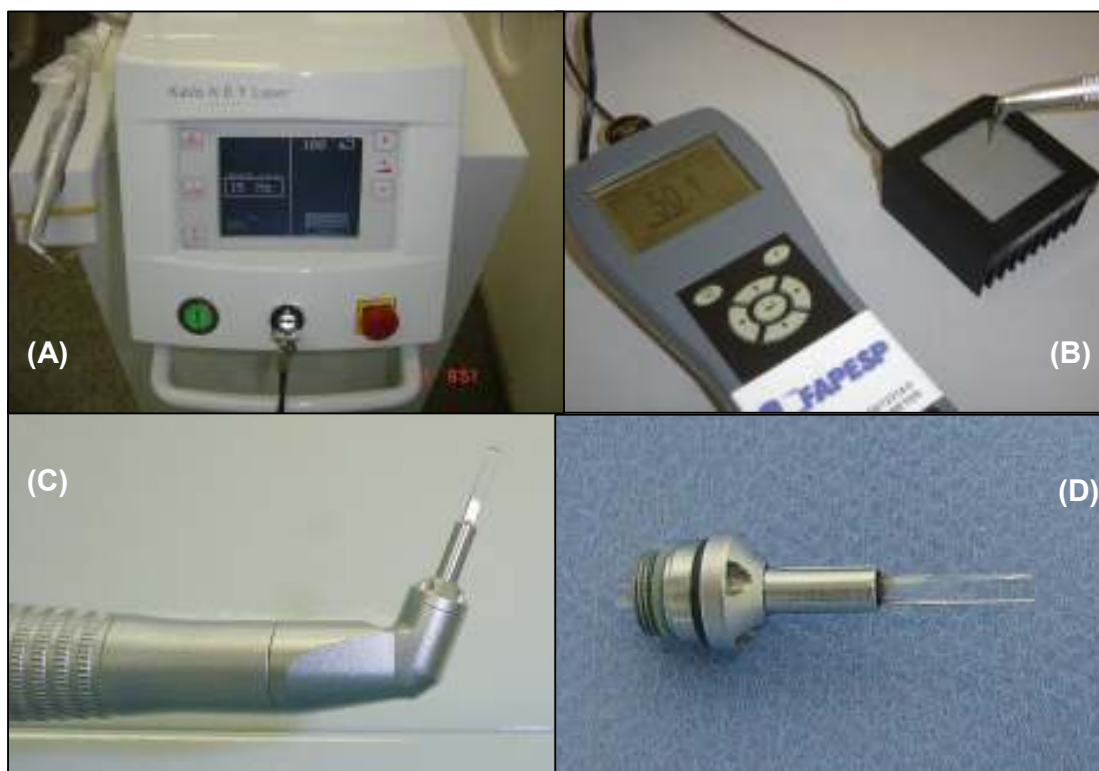
FIGURA 06 – (A) Laser de Er:YAG; (B) Medidor de potência e energia; (C) peça de mão 2056 com ponta periodontal acoplada; (D) ponta periodontal 0,5 \times 1,65\text{mm} .
