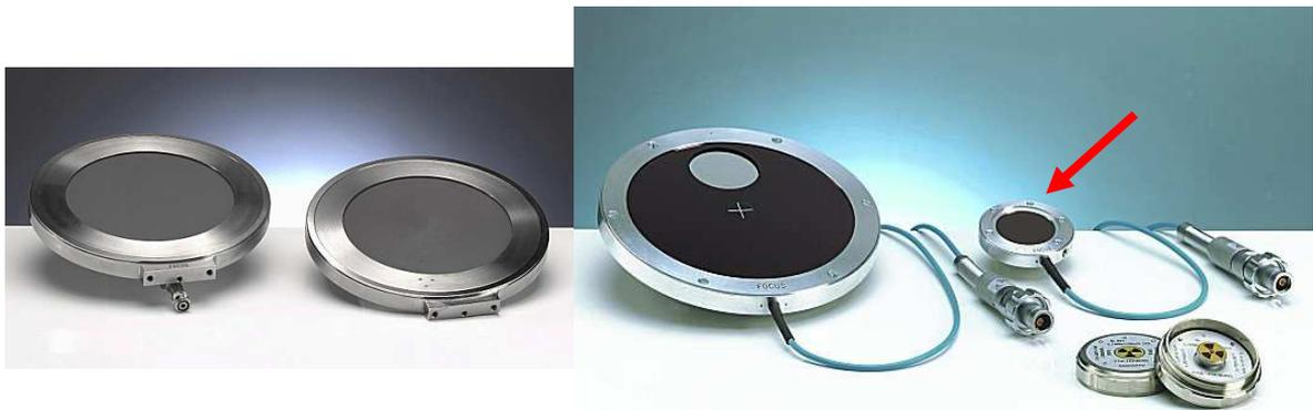
FIGURA 3.3 – Câmaras de ionização da PTW do tipo utilizado no LCI. Esquerda: câmaras de transmissão (monitoras), modelos 786 e 34014. Direita: câmara de referência para radiodiagnóstico, modelo 77334 (indicada pela seta).
