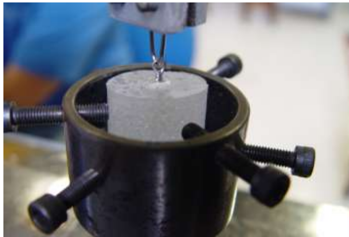
Figura 19 - Dispositivo para fixação dos corpos-de-prova
