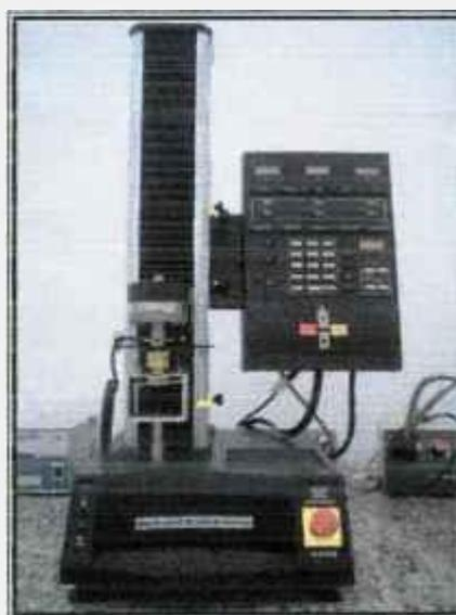
Figura 4.13 - Máquina universal de ensaio Mini-Instron, modelo 4442
