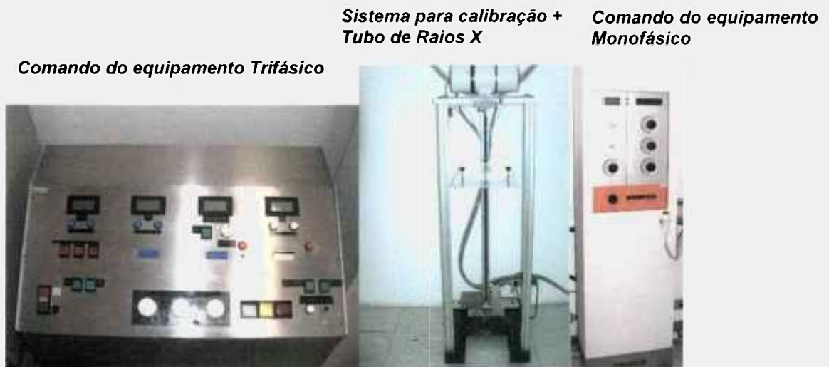
FIGURA 19: Tubo de raios X e sistema mecânico para calibração de medidores não-invasivos, comando do equipamento trifásico e comando do equipamento monofásico.
