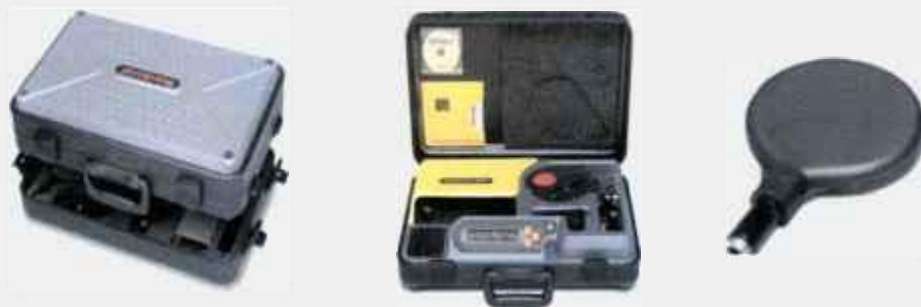
FIGURA 24: Conjunto dosimétrico Radcal 9095 composto por eletrômetro e câmara de ionização com 180\text{cm}^3 de volume.
