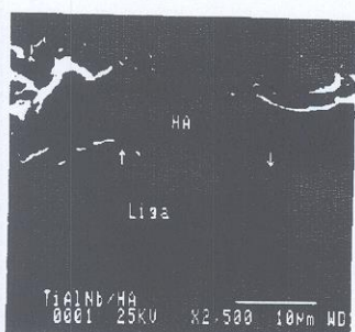
Figura 7 - Micrografia de MEV da adesão da liga Ti6Al7Nb revestida por hidroxiapatita.
