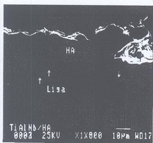
Figura 8 - Micrografia de MEV da adesão da liga Ti6Al7Nb revestida por hidroxiapatita.
