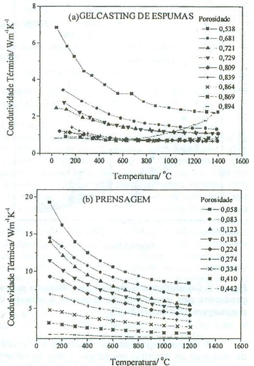
Figura 1. Condutividade térmica em função da temperatura para alumina porosa produzida através (a) do gelcasting de espumas e (b) de prensagem e sinterização a várias temperaturas [5].
