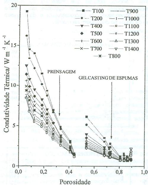
Figura 2. Condutividade térmica para alumina porosa produzida por gelcasting de espumas e através de prensagem e sinterização [5].
