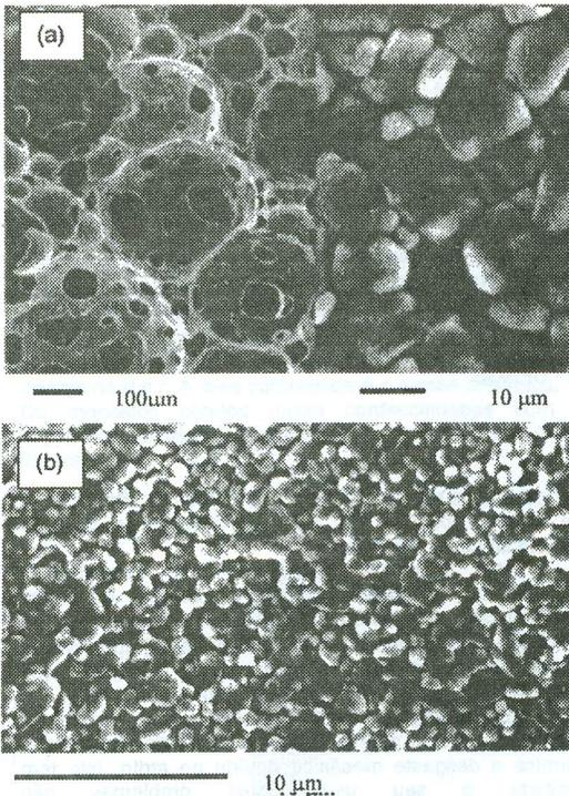
Figura 4. Micrografias mostrando a estrutura de poros das espumas cerâmicas em (a) e das amostras prensadas e sinterizadas à varias temperaturas em (b)
