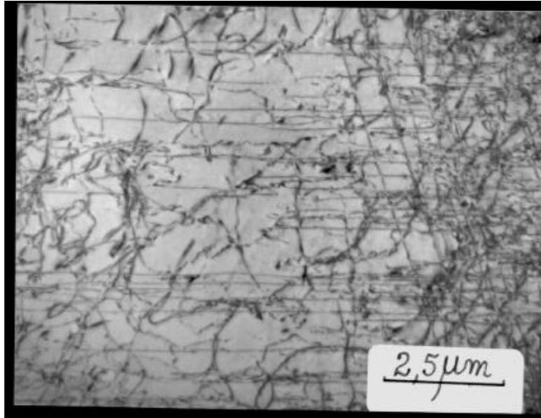
**Fig.14.- Micrografia eletrônica obtida por MET da liga AA6082 forjada.**
