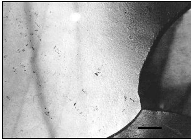
Figura 2 - Microestrutura obtida em MET , após , mostrando a distribuição de precipitados e a interação de discordâncias com os precipitados. Barra: 1 \mu m
