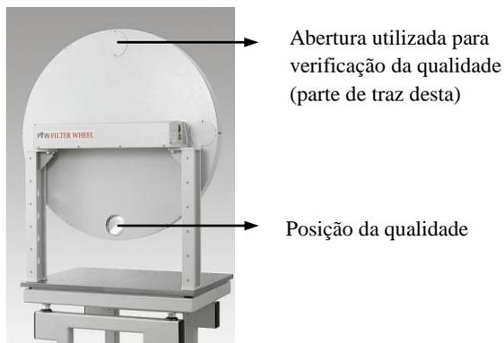
**Figura 2.** Roda de filtros automatizada da PTW. A câmara de vídeo foi posicionada direcionada para a abertura de verificação da qualidade
