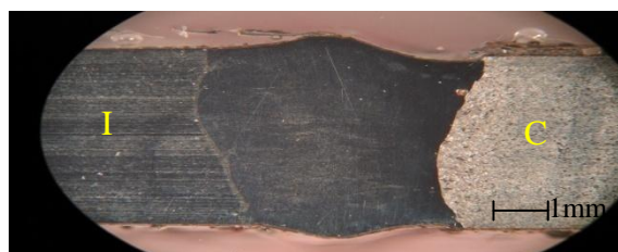
Figura 4. Micrografia da seção transversal da amostra 2 (P=3kW; V=1m/min; F = 0,5mm)
