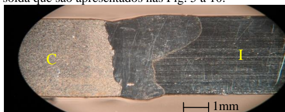
Figura 3. Micrografia da seção transversal da amostra 1 (P=2kW; V=1m/min; F = -0,5mm);
