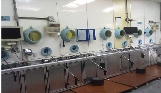
Fig. 1 Laboratório de operação de celas ^{67}\text{Ga} (Gálio), ^{201}\text{Tl} (Tálio) Janelas circulares, garras e painel de controle
