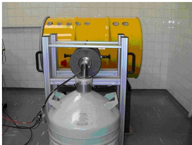
Fig. 2. Sistema composto pelo detector de HPGe e o tambor de 200 liters
