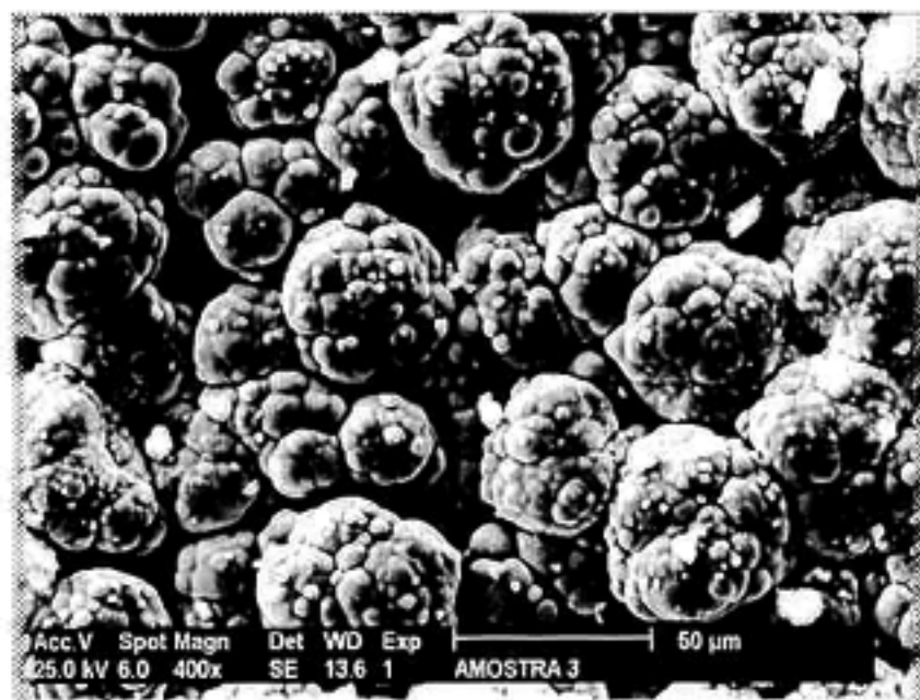
Figura 2. Morfologia do Eletrodeposição Amorfo de Fe-Cr-P em Substrato de Cobre.
