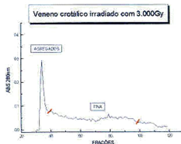
**Figura 3:** 6,0ml de uma solução à 1,81mg/ml de veneno irradiado com 3.000Gy aplicada em coluna Sephadex G-100 (71 X 2,5cm). Eluente ác. acético 100mM. Fluxo: 18ml/h. Volume coletado por fração: 3,0ml.
