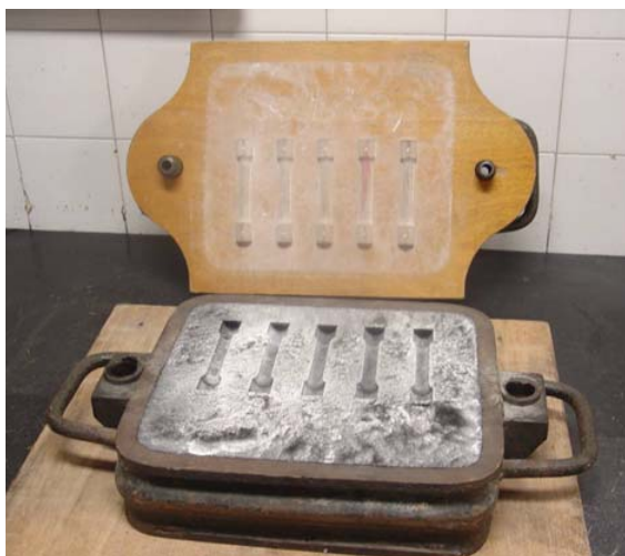
Figura 1: Modelo de madeira e molde de areia verde dos corpos-de-prova para ensaios de tração das ligas fundidas.
