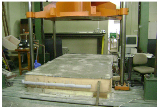
Fotografia 2. Aspecto da placa já terminada após 28 dias, tendo sob ela a laje de reação e sobre ela uma máquina hidráulica para testes de carregamento estático.
