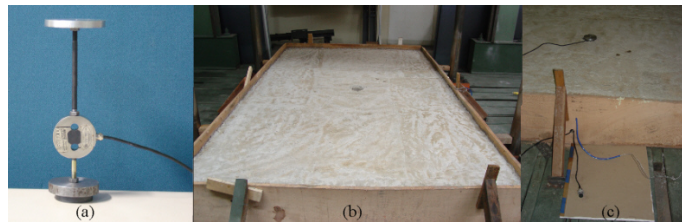
Fotografia 5 (a) célula de carga com base magnética para fixação no piso da laje de reação, (b) base com a cavidade de abrigo (poço) da célula de carga, (c) célula de carga posicionada dentro da cavidade.
