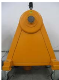
Figura 1-Irradiador gama do Laboratório de Calibração de Instrumentos do IPEN.
