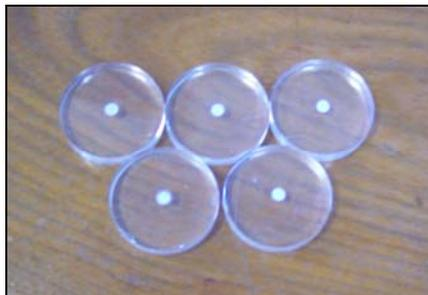
Figura 6 – Porta-dosímetros de acrílico e pastilhas de  $\text{CaSO}_4:\text{Dy}$  do sistema postal dosimétrico de calibração de aplicadores clínicos de  $^{90}\text{Sr}+^{90}\text{Y}$ .
