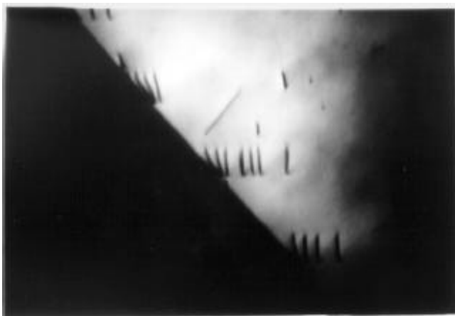
Figura 5. Microestrutura do Aço AISI 304, na Direção Transversal à Laminação. 13400 X.
