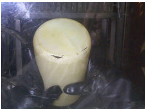
Figura 7. Frasco de Nalgene deteriorado pelo armazenamento de soluções altamente reativas e pelo longo tempo de uso ( \approx 15 anos).
