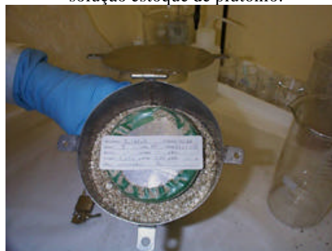
Figura 9. Vista superior da contenção de segurança da solução estoque de plutônio.
