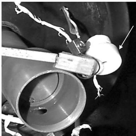
Fig. 7: Foto mostrando o sensor encapsulado.
