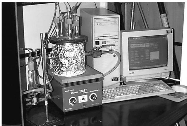
Fig. 2: Vista geral do sistema de análise da fem do sensor e da temperatura ambiente.
