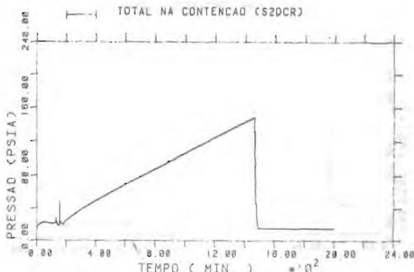
Fig. 17 Evolução temporal da pressão na contenção - caso teste
