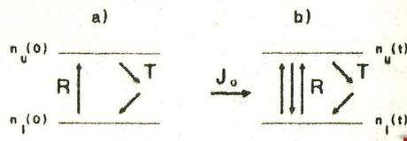
Figura 1: Processos de transições eletrônicas entre dois níveis em uma descarga elétrica. a) sem laser; b) com radiação laser ressonante.
