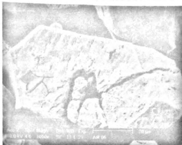
FIGURA 2- M.E.V. U_3O_8 CALCINADO (1000X)
