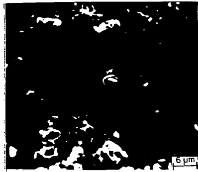
Fig.3 - Micrografia eletrônica de varredura do pó de zircônio.
