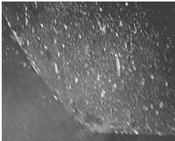
Figura 9: Campo escuro a partir da reflexão (0001) de dupla difração de um dos grãos da amostra da figura 7. (Aumento: 18.000X)
