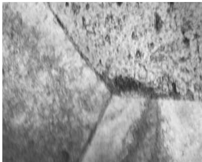
Figura 7: Micrografia observada por microscopia eletrônica de transmissão da amostra de titânio comercial grau 2. (Aumento: 18.000X)
