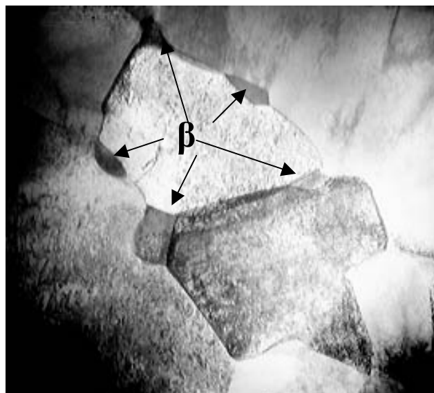
Figura 14: Micrografia observada por microscopia eletrônica de transmissão da amostra de Ti-6Al-4V, evidenciando regiões da fase \beta . (Aumento: 12.000X)
