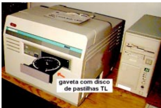
Figura 2. Leitora TL Harshaw modelo 5500 com capacidade para 50 detectores e CPU de seu microcomputador de controle.
