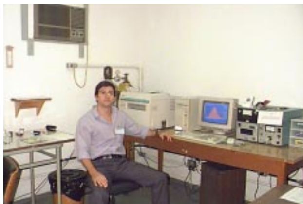
Figura 1. Sala de leitura TL. Ao fundo a leitora Harshaw modelo 5500 e à direita, a modelo 2000 AB.
