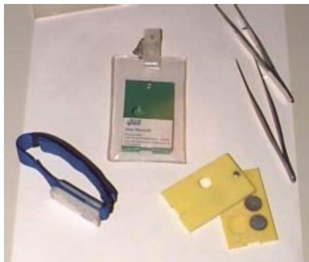
Figura 3. Verde: monitor de lapela, modelo também utilizado para dosimetria de área e ambiental. Azul: monitor de pulso. Amarelo: porta-detector aberto mostrando os filtros de chumbo. Alto à direita: pinças de manipulação.
