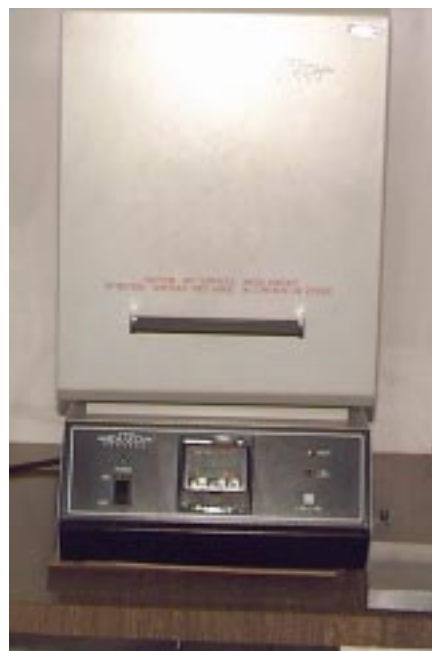
Figura 4. Mufla Lab-line Instruments modelo 4814-1, com controle digital de temperatura e variação de 1°C.
