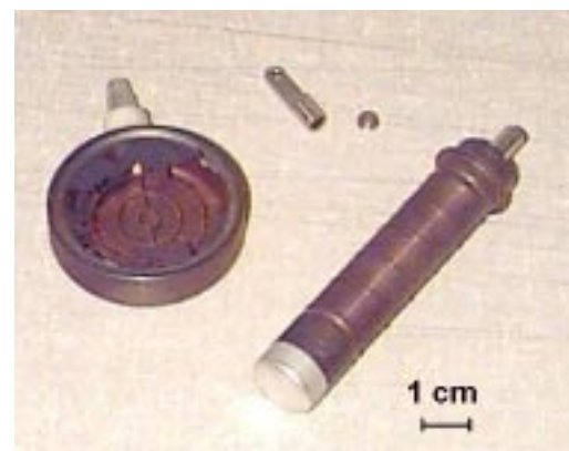
Figura 8. À esquerda: modelo de tubo Geiger-Müller circular "chato" (pancake) com a janela aberta mostrando seu catodo, empregado normalmente em monitores de contaminação. À direita: tubo Geiger-Müller dos mais comuns, utilizado em sondas externas cilíndricas. Acima ao centro: cápsula de aço e sua tampa. Nesta se insere o material radioativo e esta é soldada à tampa tornando-se uma fonte selada.
