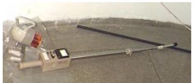
Figura 7. À esquerda um modelo de detector de radiação de área, com sua lâmpada de sinalização e abaixo um instrumento de detecção com haste de segurança.
