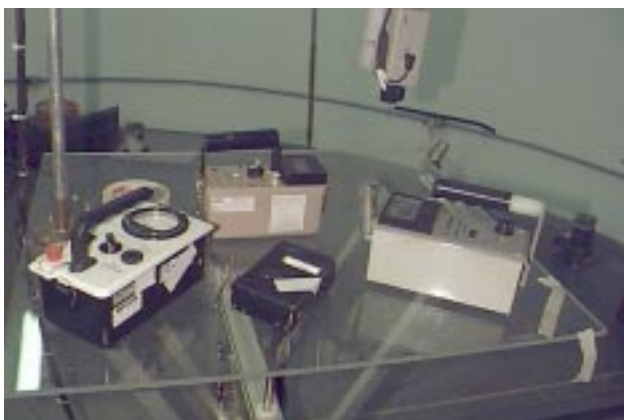
Figura 6. Quatro modelos diferentes de detectores portáteis de radiação sobre a mesa acrílica de posicionamento. Acima pode-se observar a câmera de vídeo.
