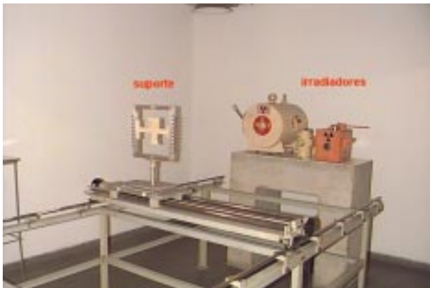
Figura 5. Sala 7 do bunker mostrando irradiadores mecânicos e "set up" de calibração.
