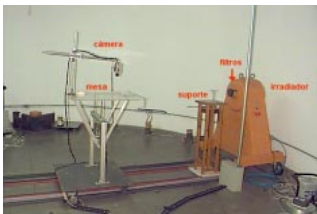
Figura 2. Sala 5 do bunker mostrando o irradiador pneumático da STS e o "set up" automatizado de calibração.
