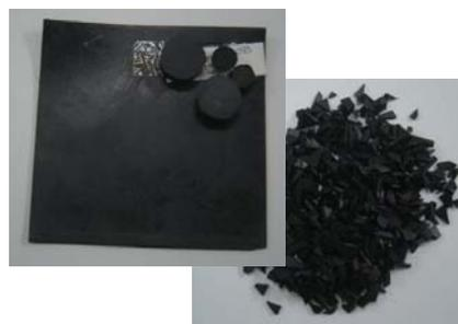
**Figura 1** – Cloropreno - manta, corpos-de-prova e amostra não irradiada.
