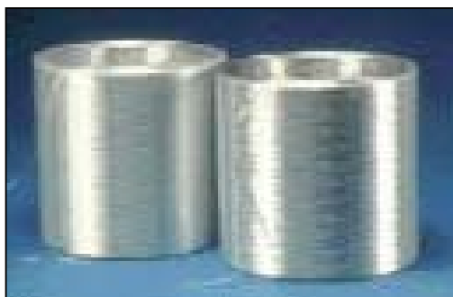
Figura 2- Rocas de fibra de vidro tipo E.
