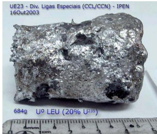
Figura 2- Urânio Metálico produzido por redução magnesiotérmica no IPEN (1)
