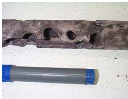
Figura 4 -Tubo de aço inoxidável inutilizado após um único ciclo de operação no sal.
