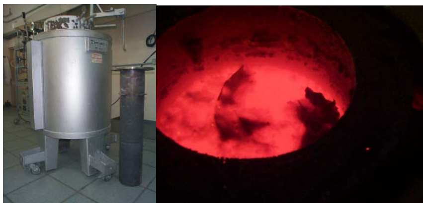
Figura 2: Sistema de aquecimento e reator (esq.), e fusão do sal no reator.
