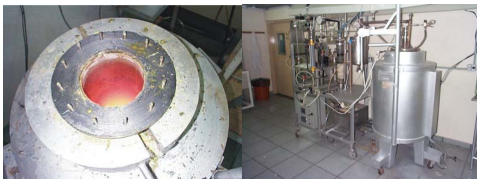
Figura 3: Reator com sal a 1000 °C (esq.) e o sistema completo desenvolvido.
