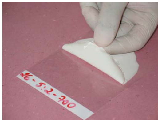
Figura 06. Fotografias de laminados de YSZ a verde, após conformação por tape casting.
