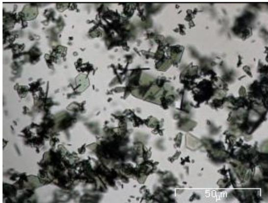
*Figura 3 – Micrografia por transmissão óptica do vidro T20R*
