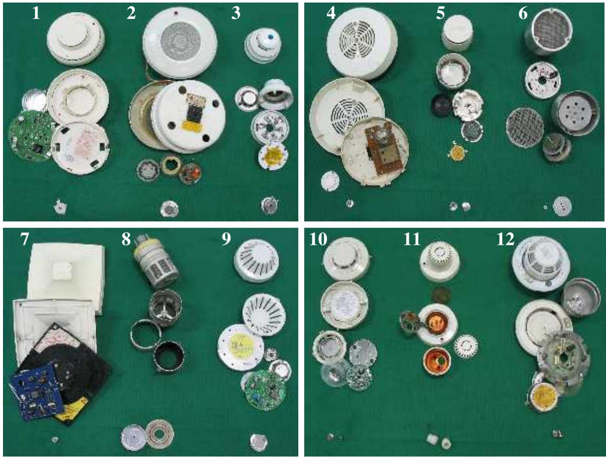
**Figura 1 – Modelos de detetores de fumaça recebidos pelo IPEN**
