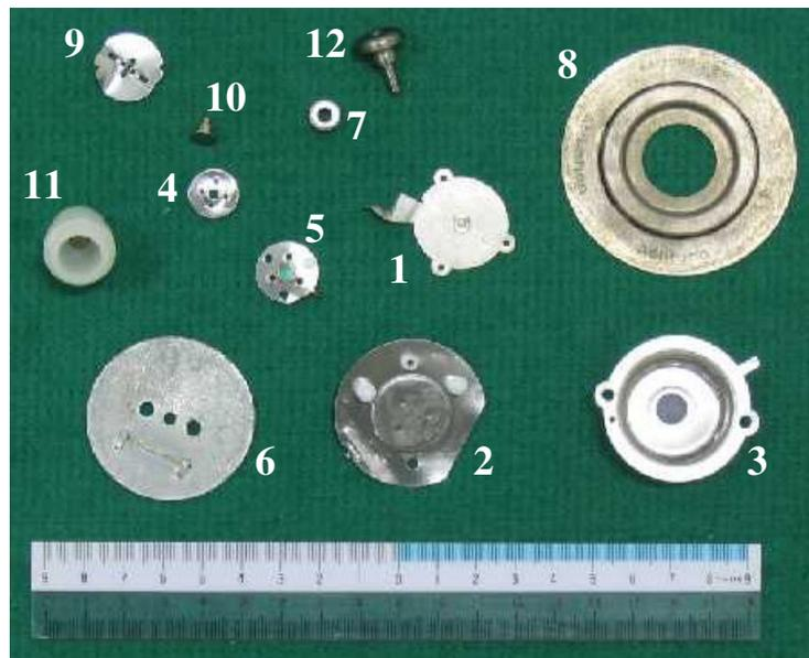
**Figura 2 – Fontes de Am-241 encontradas nos 12 modelos de detetores de fumaça**
