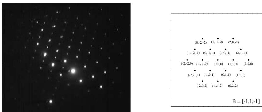
Figura 3: Padrão de difração eletrônico e indexação por DIFPAT de um grão de estrutura tetragonal, presente em cerâmicas de zircônia estabilizada com 3 mol% de ítria ou concentrado deste óxido (  $B = [-1, 1, -1]$  ).
