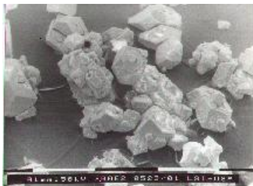
Figura 4. M.E.V. U 3 O 8 Calc. 600°C-3h
