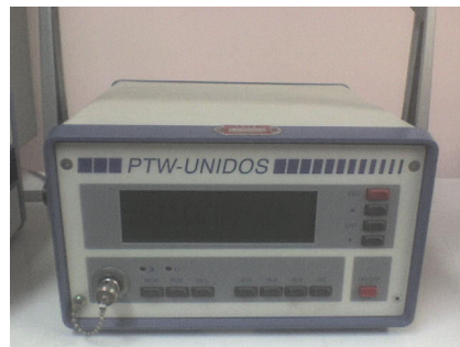
Figura 2. Eletrômetro padrão PTW Unidos do Laboratório de Calibração de Instrumentos (IPEN/CNEN).
