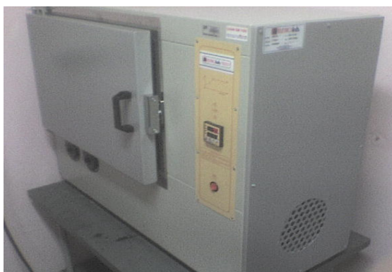
Figura 8. Estufa utilizada para retirar a umidade dos conjuntos clínicos. Esta estufa é utilizada para o tratamento dos equipamentos que apresentaram fuga e a estufa.
