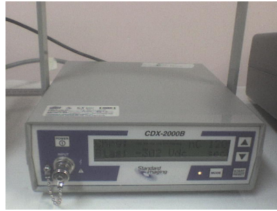
Figura 4. Exemplos de tipos de eletrômetros, sendo este Standard Imaging CDX-2000B.
