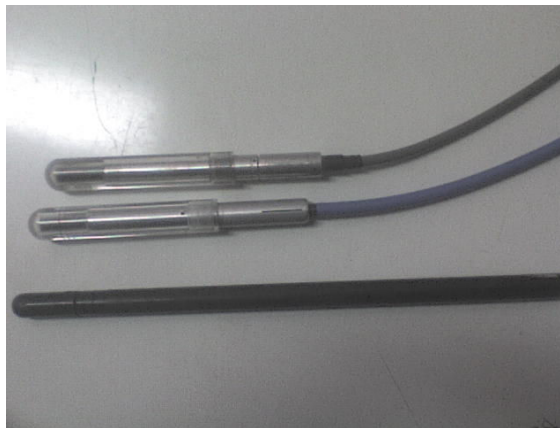
Figura 1. Câmaras de Ionização, sendo estas, a primeira de baixo para cima, Exradin A12, PTW TN 30013 e a câmara de ionização padrão NE 2507/3A do Laboratório de Calibração de Instrumentos (IPEN/CNEN).
