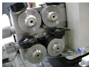
Figura 1: Rheotens 71.97 conectado à extrusora Haake para as avaliações de resistência do fundido.
