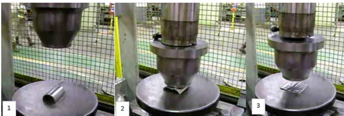
Figura 5: Ensaio de achatamento reverso. [1] Antes, [2] durante e [3] depois do ensaio. Fonte: Autor.
