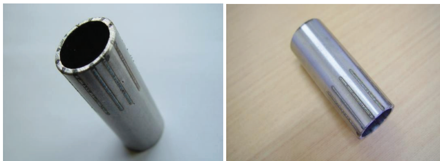
Figura 1. Tubo de aço Inoxidável Super Duplex UNS S32750 mostrando os doze cordões de solda.
