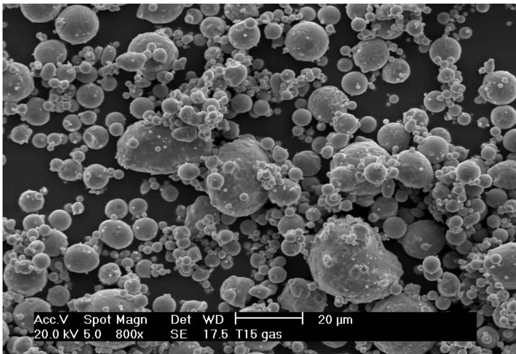
Fig.1 Pó de aço Rápido T15 como observado no MEV
