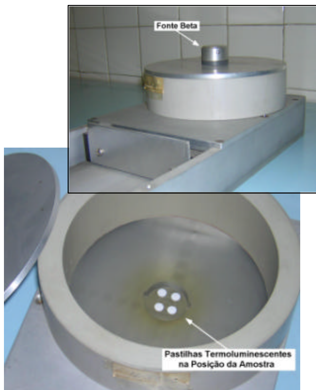
Fig. 2. Arranjo experimental para irradiação de amostras biológicas. As pastilhas ou TLDs são colocadas na posição onde uma amostra biológica é normalmente posta. No detalhe superior é mostrado o arranjo com a tampa e a fonte já posicionados.
